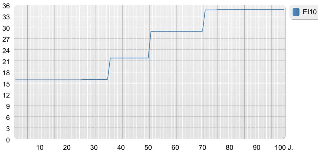
Die Trendlinie zeigt die Entwicklung der Entsorgungseinstufung EI10 über den Betrachtungszeitraum von 100 Jahren. Der Anstieg des Entsorgungsindikators wird durch den Austausch von Bauteilen und Bauteilschichten, die ihre Nutzungsdauer erreicht haben, hervorgerufen.
