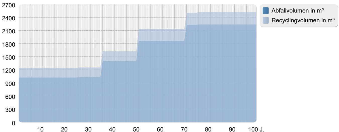
Die Trendlinien zeigen das anfallende Entsorgungsvolumen, aufgeteilt in Abfallvolumen und Recyclingvolumen, über den Betrachtungszeitraum von 100 Jahren. Das beim Austausch von Bauteilen und Bauteilschichten anfallende Entsorgungsvolumen ist durch den Anstieg der Kurven erkennbar.
