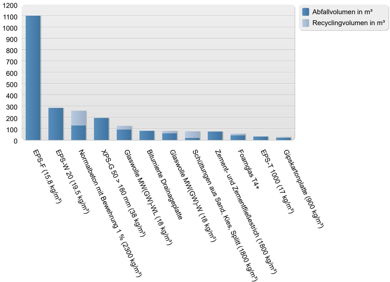
Entsorgungsvolumen der wesentlichen 12 die Materialien aufgeteilt in Abfallvolumen und Recyclingvolumen in m³ in absteigender Reihenfolge. Das Entsorgungsvolumen wird unter Berücksichtigung der Entsorgungseinstufung, des Verwertungspotentials und der Nutzungsdauer des Materials über den Betrachtungszeitraum ermittelt.
