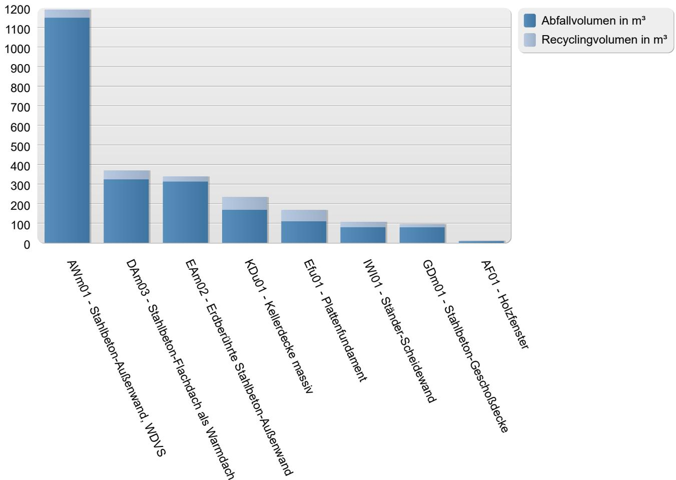
Entsorgungsvolumen der wesentlichen 8 Bauteile aufgeteilt in Abfallvolumen und Recyclingvolumen in m³ in absteigender Reihenfolge. Das Entsorgungsvolumen wird unter Berücksichtigung der Entsorgungseinstufung, des Verwertungspotentials und der Nutzungsdauer von Bauteilen/-teilschichten über den Betrachtungszeitraum ermittelt.
